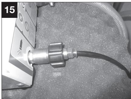
6. Verificare che l'acqua dell'impianto idrico centralizzato abbia una pressione compresa tra i 2 ed i 5 bar (30 - 70 psi), aprire a questo punto il rubinetto per alimentare la macchina.
